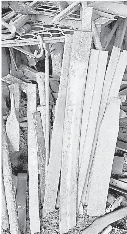
万利打铁铺采用汽车弹簧钢板打刀，这种材质锻造的刀坚固、锋利又耐用。
