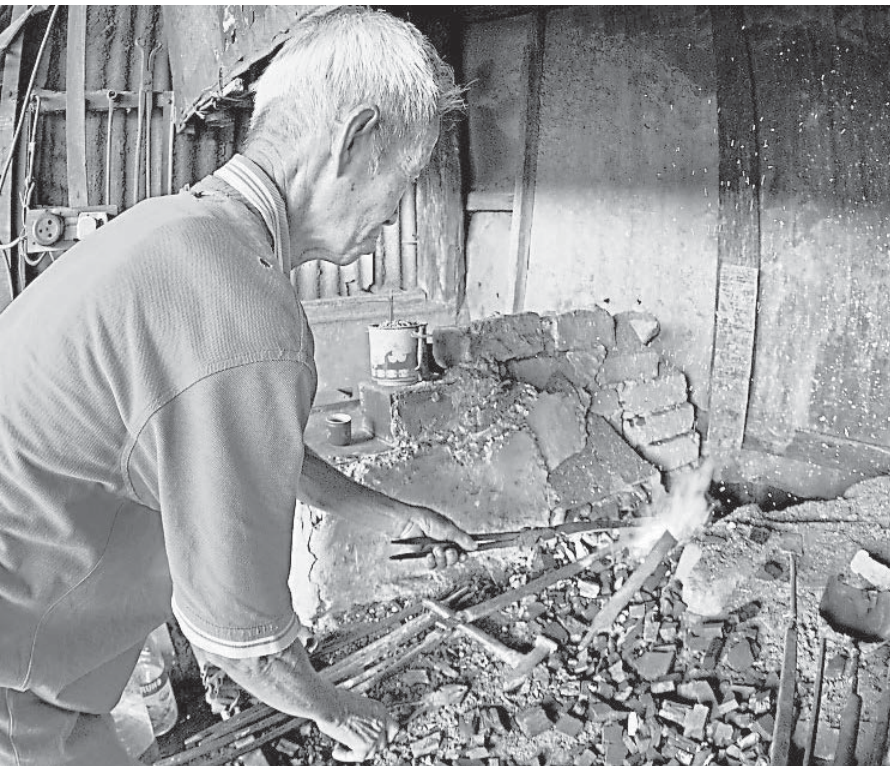
烧红的铁器移到铁砧上锻打塑形，一手握铁钳不断翻转铁器，另一手用铁锤敲打，不经一番苦功夫，不得利刃琢磨成形。
