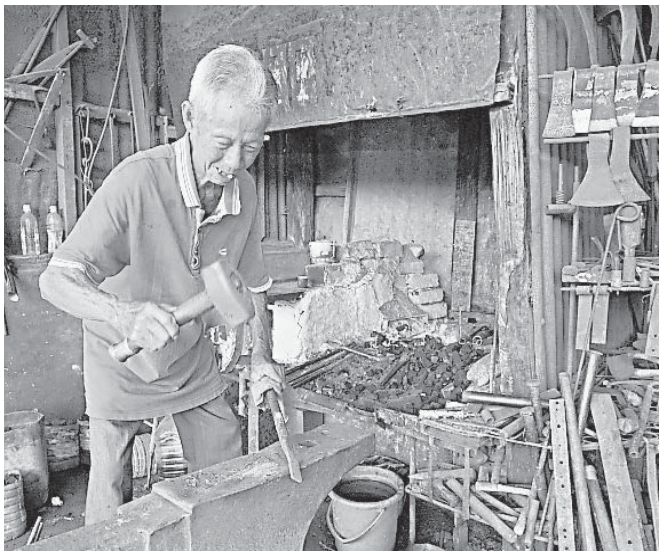
烧红的铁器移到铁砧上锻打塑形，一手握铁钳不断翻转铁器，另一手用铁锤敲打，不经一番苦功夫，不得利刃琢磨成形。
