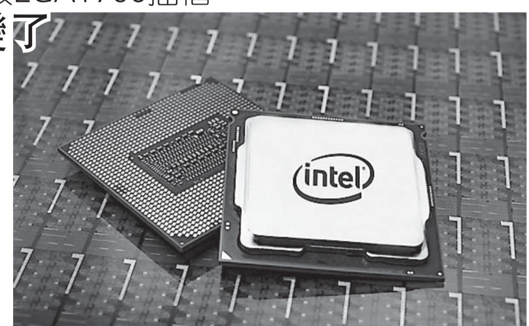
容了，因为最新爆料显示LGA1700平台的散热孔距从LGA115X/1200的75x75变成了78x78，直逼LGA2011/2066平台的80x80孔距。
