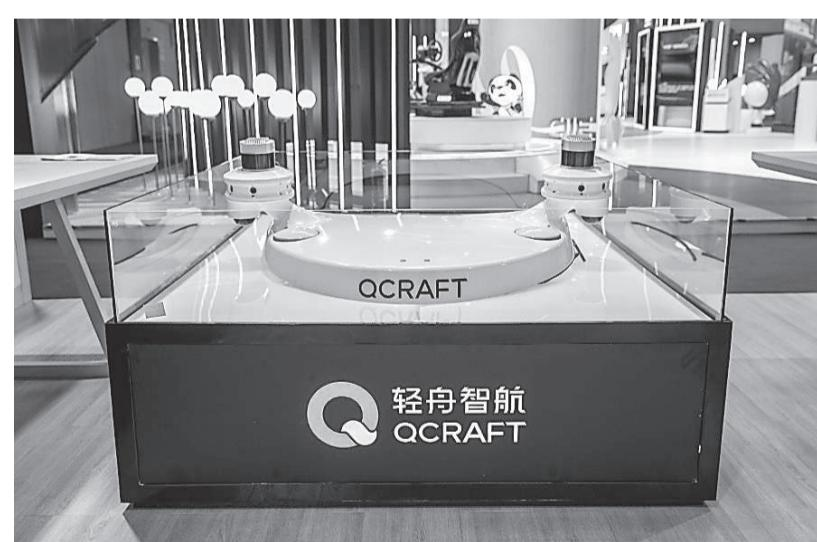
中国自动驾驶公司轻舟智航近日发布Driven-by-QCraft第三代L4级自动驾驶硬件方案。据悉，该方案基于多传感器融合技术，采用易于部署的模块化设计，整合了2个长距离测量激光雷达、3个近距离补盲激光雷达、4个毫米波雷达、9个感知摄像头和1个IMU。
