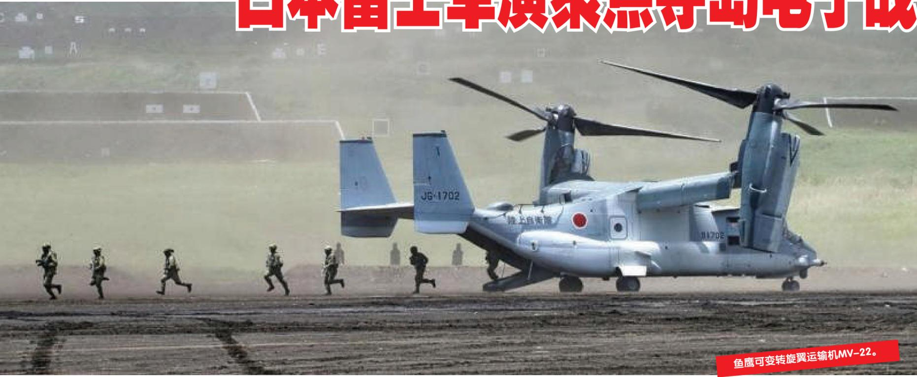
鱼鹰可变速旋翼运输机MV-22。
