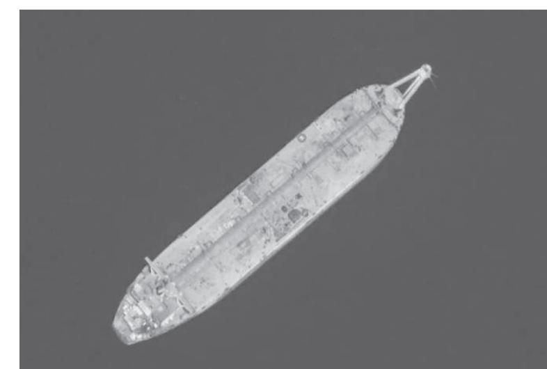
万桶原油，但由于缺乏维护，船体结构已严重老化，面临解体风险。
