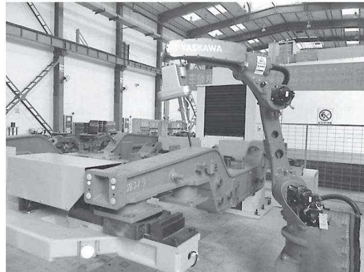
中国首个实现构架自动探伤的智能机器人在无锡地铁西漳车辆段正式投用。
