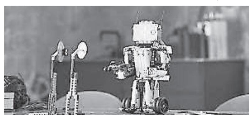
乐高Mindstorms是乐高的机器人系列，该系列包括一整套的软硬件，可以让用户搭建自己的可编程机器人。该系列创建于1998年，目前已先后发布三代。
