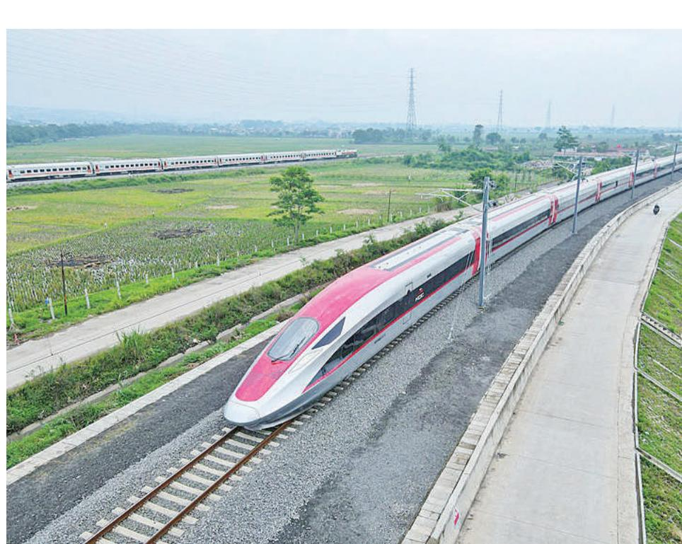
一列高铁动车组正在雅万高铁试验段进行热滑试验。
