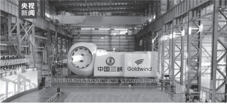
中国自主研制的16兆瓦海上风电机组在福建三峡海上风电国际产业园下线。机组单机容量16兆瓦海上风电机组，叶轮直径252米，叶轮扫风面积约5万平方米，约相当于7个标准足球场大；轮毂高度达146米，相当于一座50层大楼的高度。这是目前全球范围内单机容量最大、叶轮直径最大、单位兆瓦重量最轻的风电机组，标志着我国海上风电大容量机组在高端装备制造能力上实现重要突破，达到国际领先水平。
