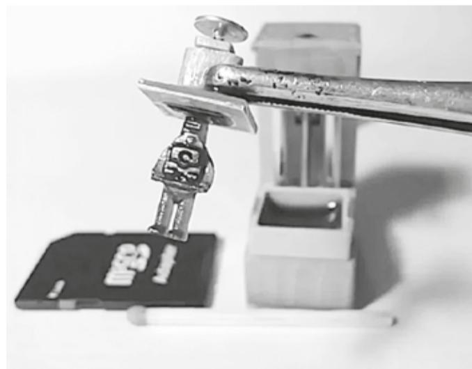
打印（3DP）即快速成型技术的一种，又称增材制造。它是一种以数字模型文件为基础，运用粉末状金属或塑料等可粘合材料，通过逐层打印的方式来构造物体的技术。
