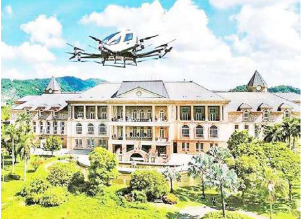
亿航智慧自主研发的飞行器EH216-S：纯电力驱动的自动驾驶飞行器。
