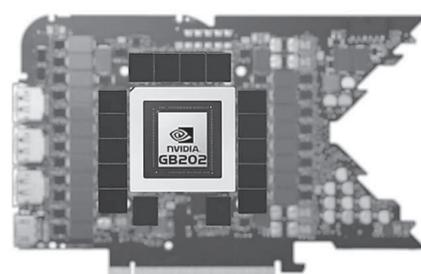
NVIDIA下一代显卡RTX 5090的规格逐渐揭晓，最新消息显示，RTX 5090所采用的GB202 GPU尺寸为744平方毫米 (24\*31MM)，封装尺寸为3528平方毫米 (63\*56MM)。
